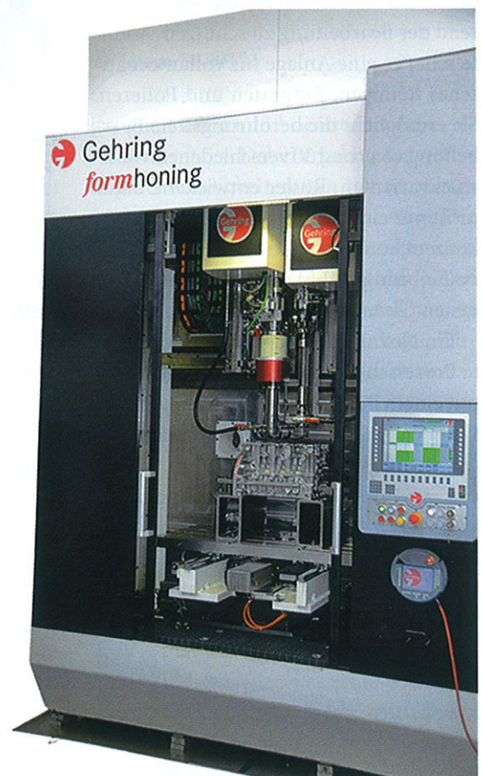
3 Standard-Honmaschine PT 600, eingerichtet zum Formhonen und Glätten
