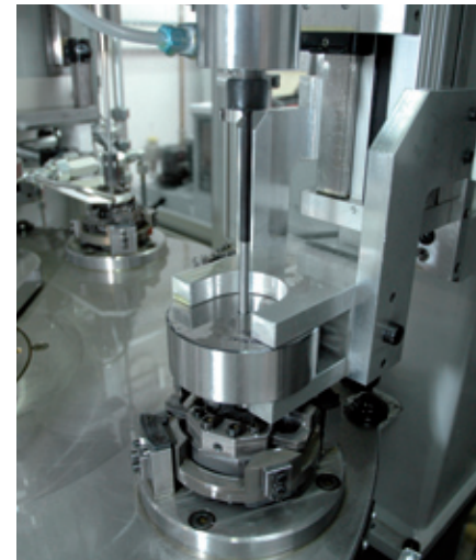
Nachmessstation einer mehrspindligen Maschine
