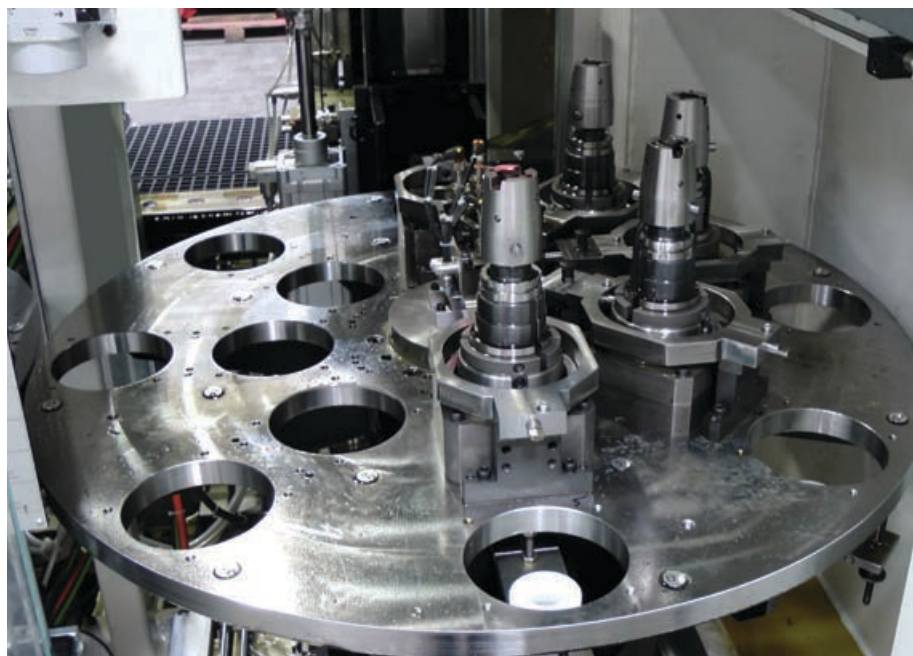
Werkzeugwechsler für PT-Modul und Transfer mit bis zu 24 Werkzeugen
