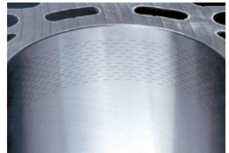
Zylinderlaufbahn nach der Laserhonenbearbeitung
